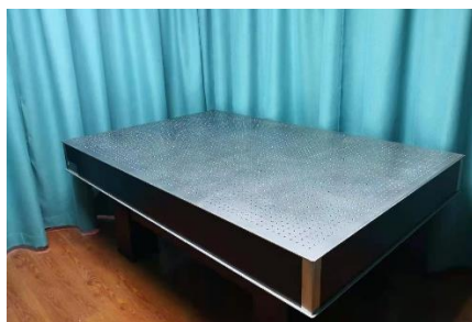
图 9 原位显微共焦拉曼光谱仪的光学台面装置图
